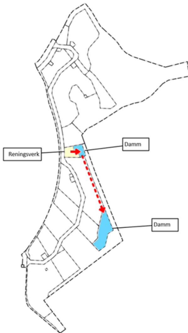
Föreslagen lokalisering av reningsverk och efterföljande dammar.
