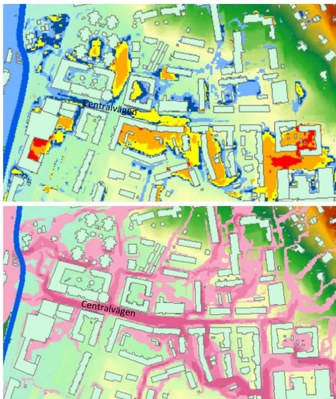
Figur 14 Översvämningsproblematiken i korsningen Centralvägen/Industrivägen. Till väster visar röd markering området som bidrar med avrinning till Centralvägen, uppe till höger beräknade maximala vattendjup i längs och kring Centralvägen och nere till höger inzoomad bild av flödesvägarna.
